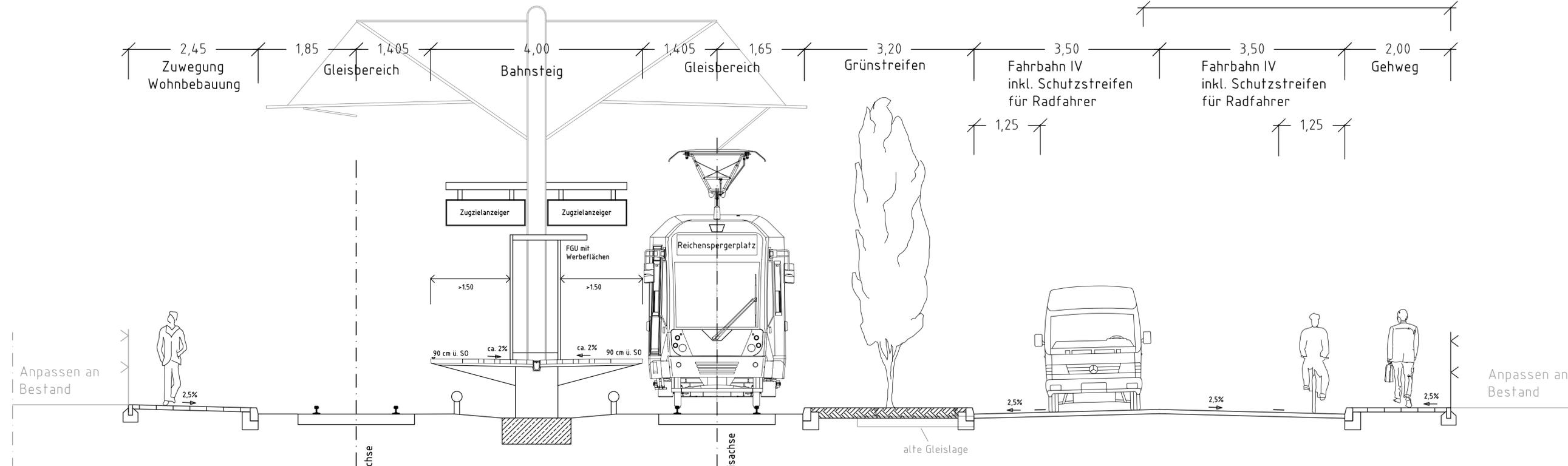
Der Schutzraum entlang der Rampe und des Bahnsteigs befindet sich im angrenzenden Gehweg bzw. Grünstreifen. Der Bereich unterhalb des Bahnsteigs wird mit geeigneten Maßnahmen, z.B. einer Rohrkonstruktion, die noch im Detail im Rahmen der Ausführungsplanung abgestimmt wird, unzugänglich gemacht.
