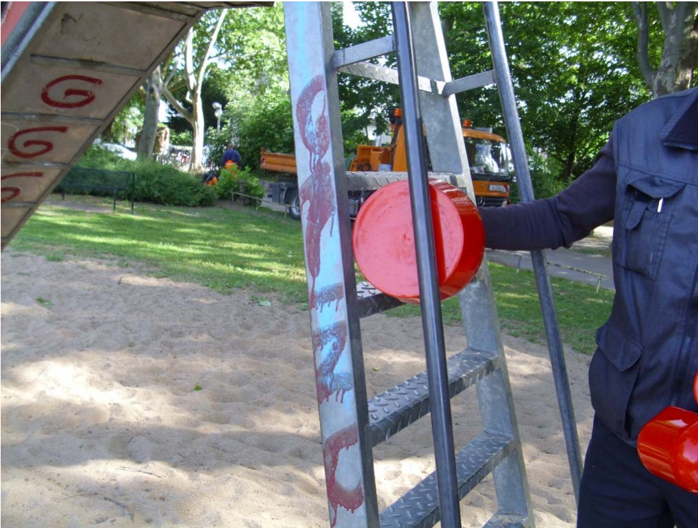
Abb. 3.: Der Prüfkörper D (Körperfangstelle) lässt sich jedoch nicht durch die Öffnung führen: Hier liegt eine unzulässige Fangstelle für Kopf und Hals vor (damit keine Unfallgefahr vorliegt, müssten beide Prüfkörper durchgehen).
