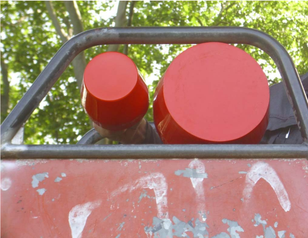
Abb. 5: Fangstelle in den Wangen des Einsatzbereiches der Rutsche; siehe oben. Um den Vorgaben der DIN EN 1176 zu entsprechen, müssten sich beide Prüfkörper durch die Öffnungen führen lassen – oder keiner der beiden Prüfkörper: es liegt eine unzulässige Fangstelle für Kopf und Hals vor (Prüfkörper klein: Kopffangstelle; Prüfkörper groß: Körperfangstelle).
