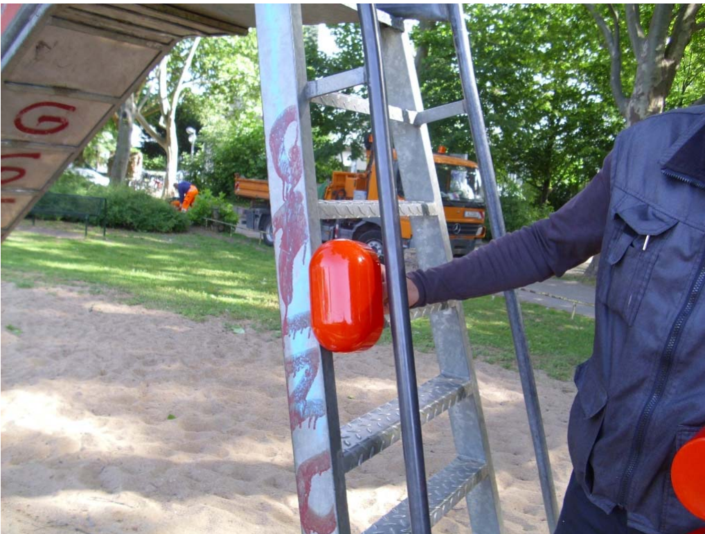
Abb. 2: Handlauf des Rutschenaufstieges; vollständig umschlossene Öffnung, der Prüfkörper C (Kopffangstelle) lässt sich durch die Öffnung führen (sollte nicht).
