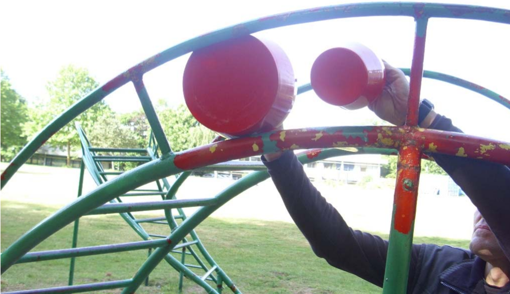
Abb. 7: Fangstellen zwischen Sprossenaufstieg und Handläufen der „Achterbahn“; siehe oben: unzulässige Fangstelle für Kopf und Hals. Um den Vorgaben der DIN EN 1176 zu entsprechen, müssten sich beide Prüfkörper durch die Öffnungen führen lassen – oder keiner der beiden Prüfkörper: es liegt eine unzulässige Fangstelle für Kopf und Hals vor (Prüfkörper klein: Kopffangstelle; Prüfkörper groß: Körperfangstelle).
