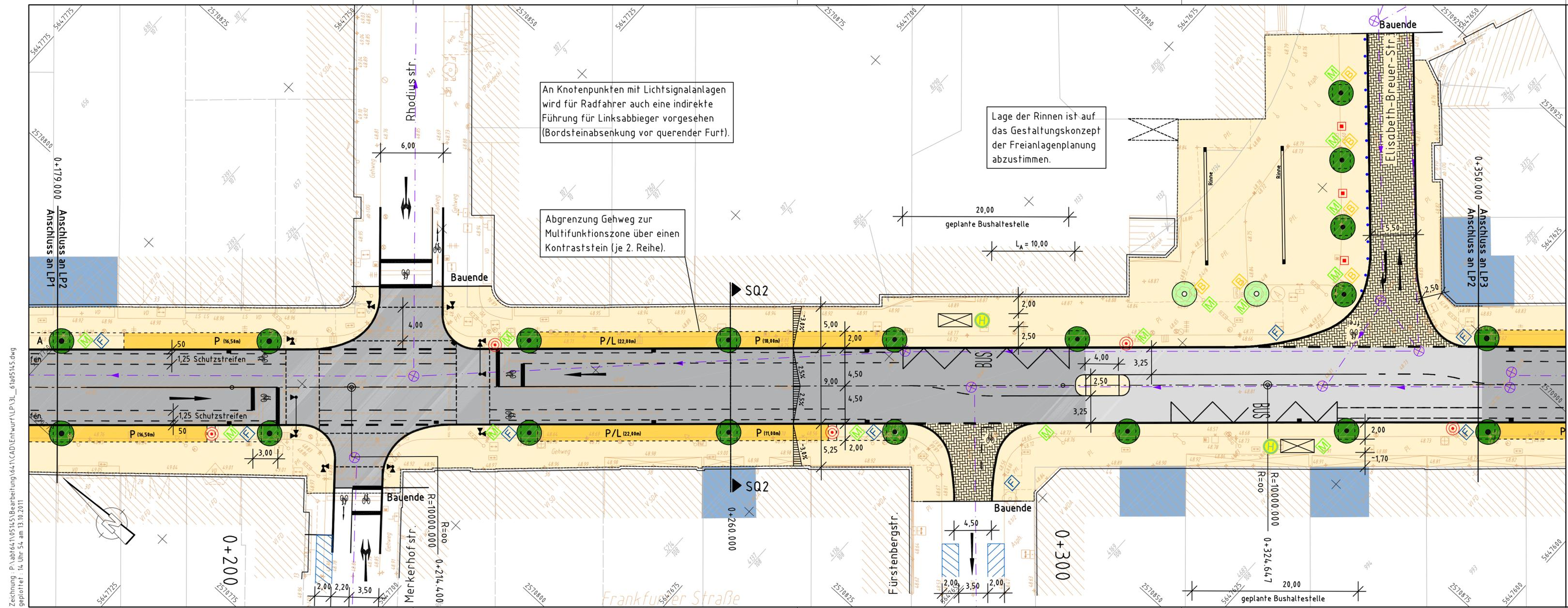
An Knotenpunkten mit Lichtsignalanlagen wird für Radfahrer auch eine indirekte Führung für Linksabbieger vorgesehen (Bordsteinabsenkung vor querender Furt).
