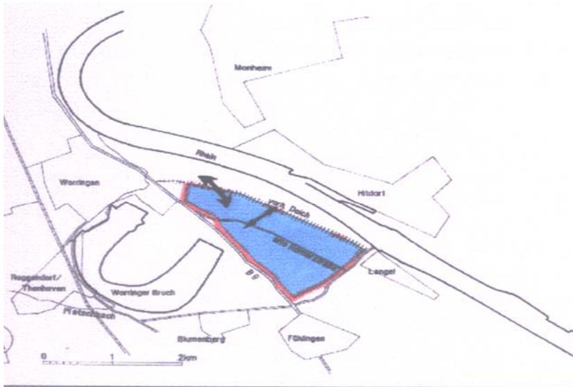
**Abbildung 5: Kleiner Retentionsraum, überflutete Fläche**
