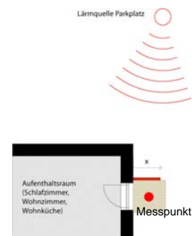
V3b: Seitlich abschirmende Prallscheibe vor Balkon
