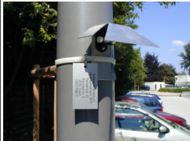
Passivsammler für Benzol im Schutzgehäuse
