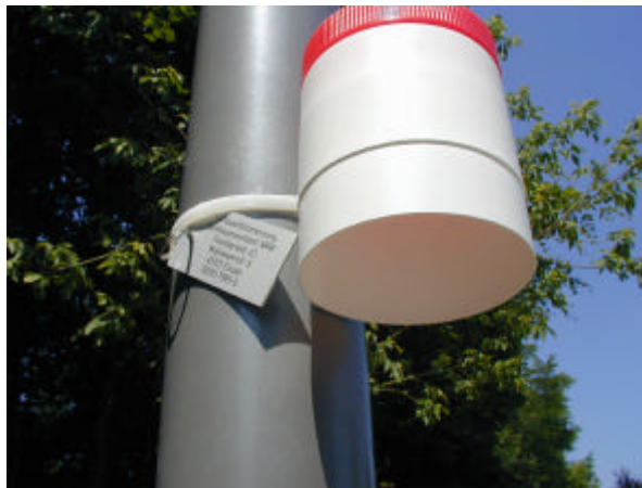
Passivsammler für NO 2 im Schutzgehäuse
