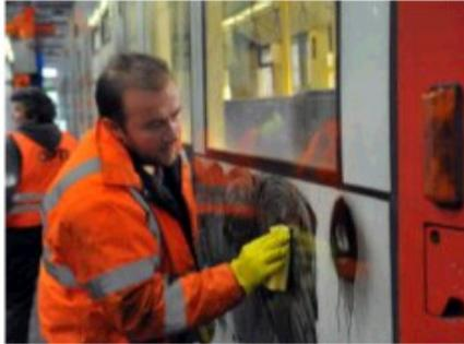
Von Hand werden Graffiti auf KVB-Bahnen mit Lösungsmitteln entfernt. Gegen das Zerkratzen von Fensterscheiben („Scratching“) hilft nur ein Komplettaustausch.
