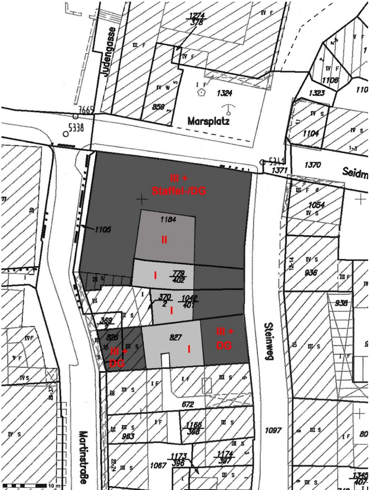
Abb. 03: Skizze zur Bebaubarkeit des Planungsareals gemäß § 34 BauGB
