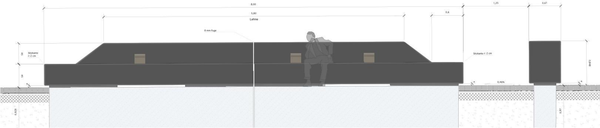
Frontseite Betonbank mit Lehne auf dem Rathausplatz / Spanischer Bau
