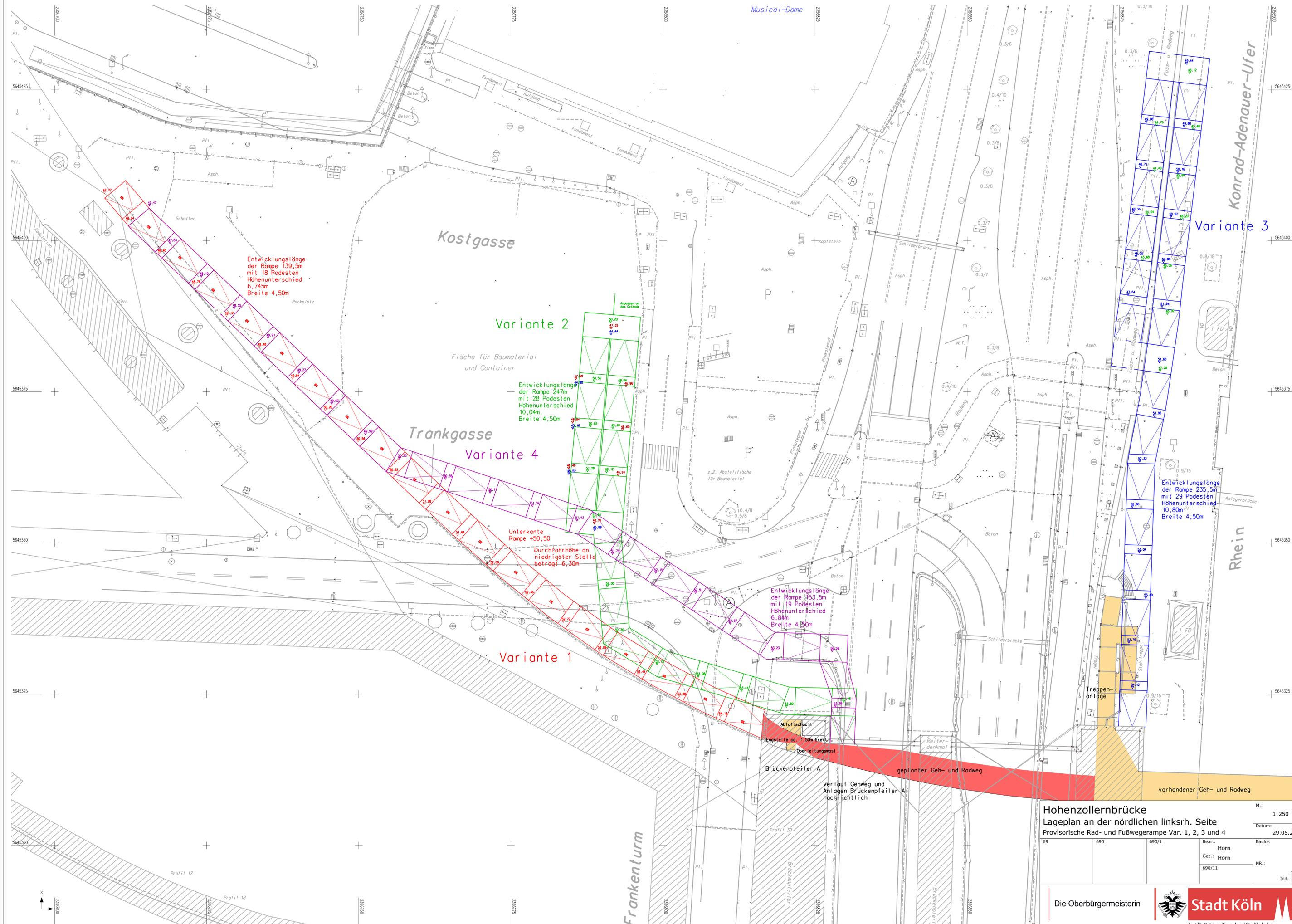
Entwicklungslänge der Rampe 139,5m mit 18 Podesten Höhenunterschied 6,745m Breite 4,50m
