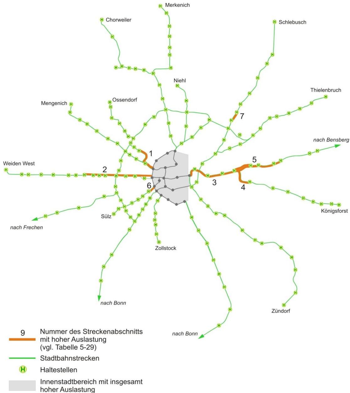
Abbildung 2: Hohe Auslastungsgrade im Stadtbahnnetz montags bis freitags im Zeitabschnitt 12:00 Uhr bis 19:00 Uhr, Stand: 2009
