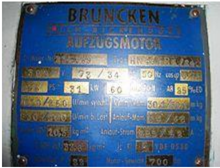
Typschild eines Aufzugsmotors der Firma Bruncken
